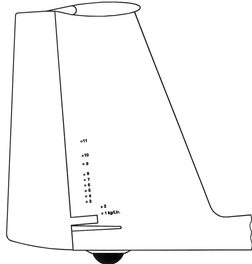
**Das Ablassen des Wassers in der Seitenflosse** erfolgt durch eine Bohrung im Rumpf vor dem Seitenruder. Der Ablaßmechanismus ist mechanisch mit der Betätigung für den Flügelwasserballast gekoppelt, so daß die Wassertanks in den Flügeln und in der Seitenflosse immer gleichzeitig geöffnet werden.
